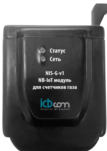
Рис. 1 – Модуль NB-IoT (НИС-Г) для счетчика газа ВК-G4 Elster
